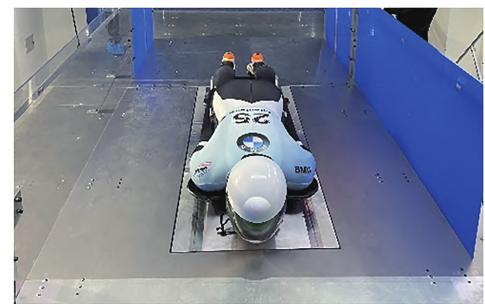
图 4 钢架雪车风洞实验状态
